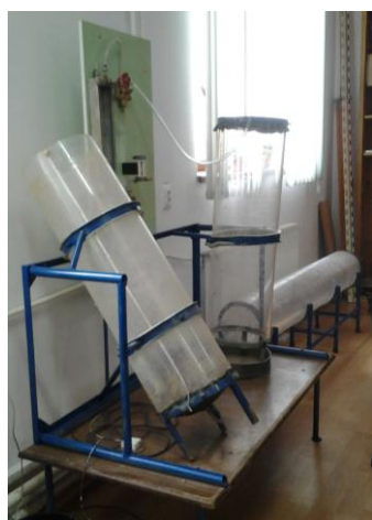
Fig. 13. Stand de determinare a permeabilității solurilor la poluanți lichizi și gazoși
