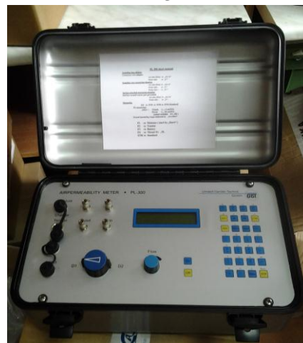
Fig. 16. Permeamtru pentru determinarea permeabilității la aer a solurilor PL300
